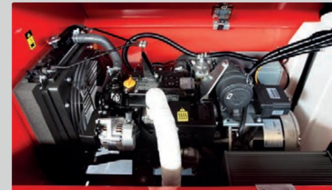
Las torres de iluminación AS4006 / AS4006V / AS4008 han sido diseñadas con dos puertas laterales abatibles, en la parte superior, que facilitan el acceso para realizar tareas de mantenimiento del motor y alternador.
