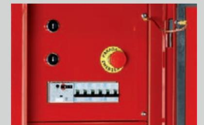
Los pulsadores de maniobra permiten controlar el mástil mediante dos simples botones. Uno de ellos acciona la elevación del mástil hidráulico hasta una altura máxima 9 metros. El pulsador inferior controla el descenso del mástil hasta la recogida del mismo. Los interruptores magnetotérmicos inferiores regulan el encendido y apagado de los focos. Incluye un pulsador de parada de emergencia.
