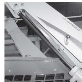
Figura 3: Dispositivo de soporte del brazo de elevación enganchado
