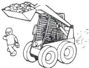
! La cargadora nunca debe permanecer sola, con el motor encendido o el brazo de elevación en posición elevada. Para estacionar, active el freno de estacionamiento y coloque el implemento al nivel del suelo.
