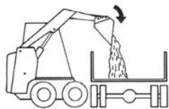
Figura 22: Vaciar la carga en una caja
