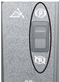
Figura 2: Interruptor del freno de estacionamiento
