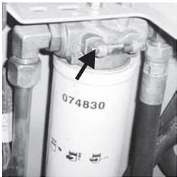
**Figura 36: Filtro e indicador del filtro de aceite hidráulico**
