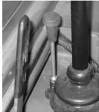
**Figura 17: Palanca de control del flujo alto**
