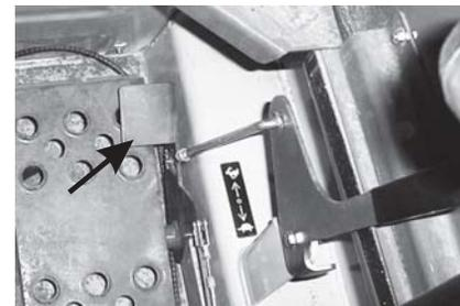
**Figura 7: Acelerador de pie (unidades con controles de barra T y manual dobles)**
