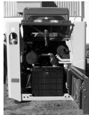
Figura 28: Puertas de acceso del compartimiento del motor
