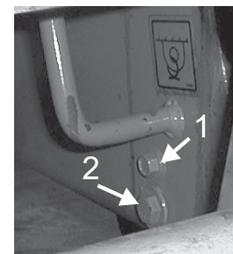
Figura 32: Tapones de comprobación y drenados
